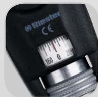
La vis moletée permet de faire pivoter la tache en forme de trait ou de point sur 360°. La mesure de l'angle correspondant peut être lue sur la graduation.
